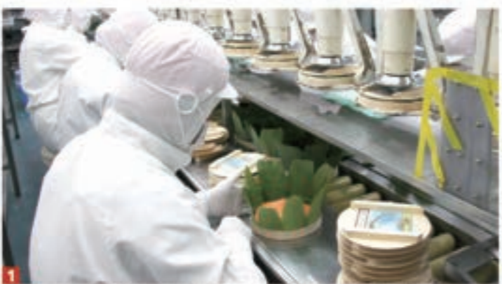
1 ますのすしの盛り付け工程。曲げ物に笹を敷き、その上にすし飯とマスの身をのせてふたを開け、押し機で圧力を加える
